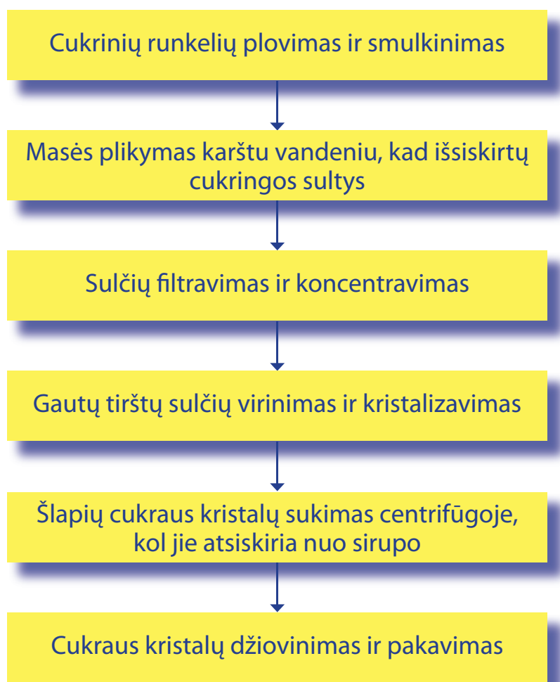
92 pav. Pagrindiniai cukraus iš cukrinių runkelių gamybos etapai Šaltinis: Smičienė, D. (2007). Maisto prekės . Vilnius: Baltos lankos.
